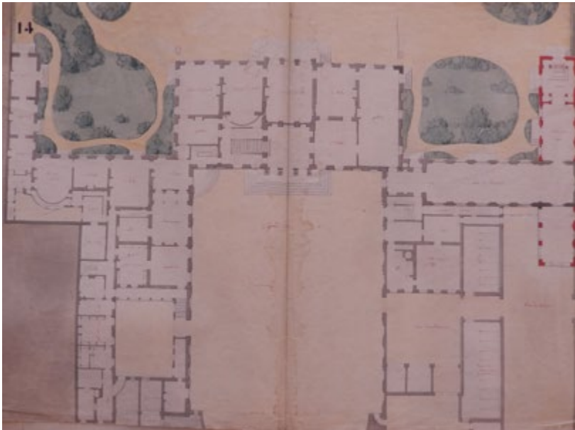
Figure 10. Étienne-Chérubin Leconte (attribué à), plan partiel du rez-de-chaussée de l'Élysée après la construction de l'escalier d'honneur et de la salle de banquet. Rez-de-chaussée avec l'indication de l'affectation des pièces et, en rouge, projet non exécuté d'agrandissement et prolongement de l'aile ouest, pour Joachim Murat, grand-duc de Berg et Clèves, dessin, crayon, encre noir et aquarelle, s.d. [avant 1808]. Paris, Archives nationales, Cartes et plans, VA XII, 5 (© Geoffroy, Guidoboni 2018).
