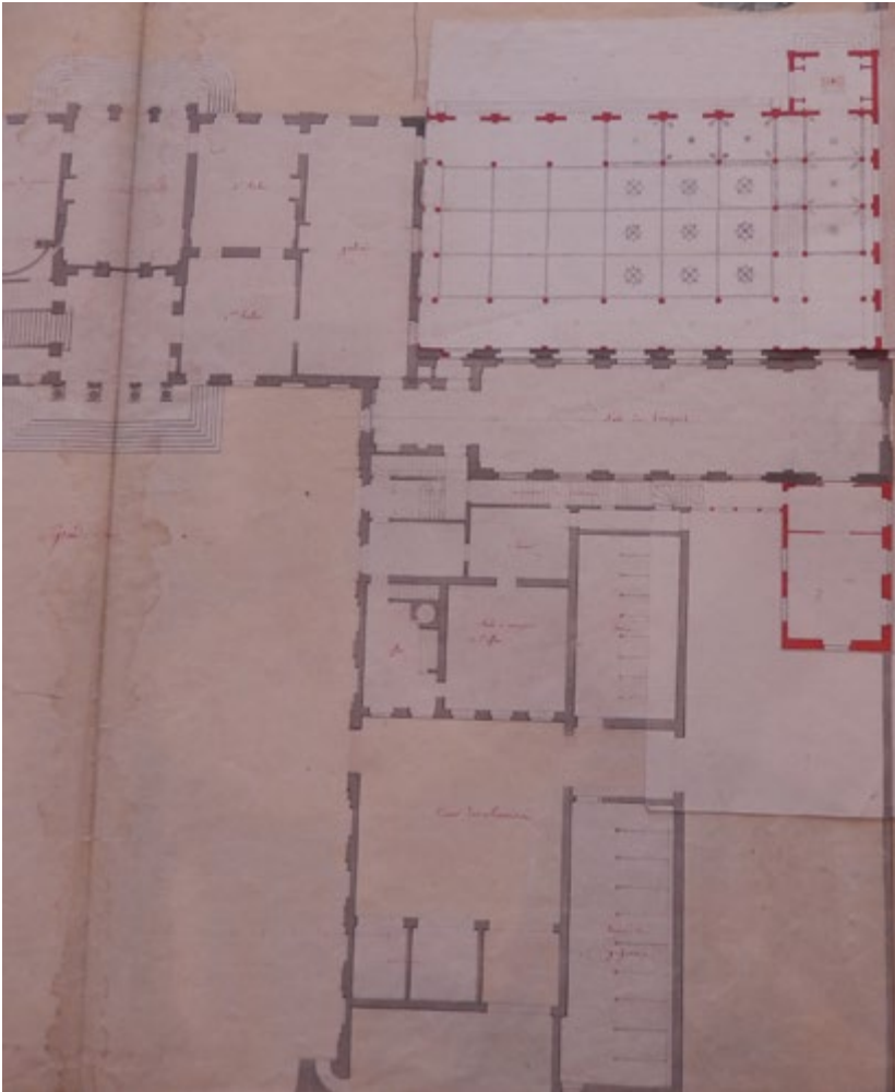
Figure 22. Étienne-Chérubin Leconte (attribué à), plan partiel du rez-de-chaussée de l'Élysée après la construction de l'escalier d'honneur et de la salle de banquet. Détail de la grande salle des fêtes [sur retombe] en prolongement de l'aile ouest, pour Joachim Murat, grand-duc de Berg et Clèves, dessin crayon, encre noir et aquarelle, s.d. [avant 1808]. Paris, Archives nationales, Cartes et plans, VA XII, 5 (© Geoffroy, Guidoboni 2018).
