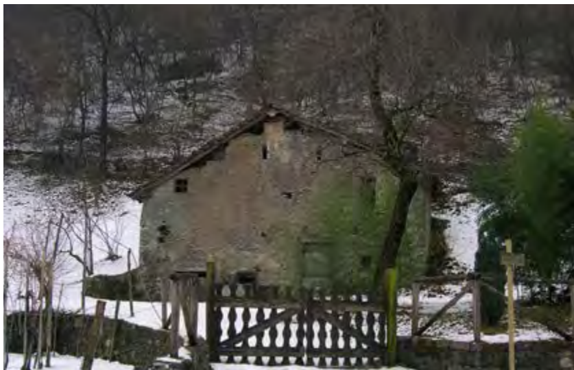
Figura 1. Civitate, Brescia, cascina Fratelli Gozio. È evidente come la cascina risponda alle esigenze di protezione dal freddo: le finestre piccole, la posizione riparata dalla montagna e dal bosco retrostante (foto B. Scala).
