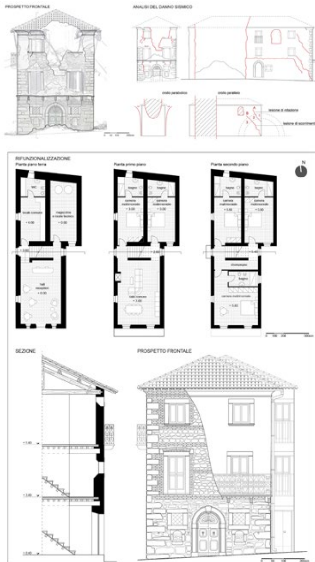
Figura 8. Retrosi, frazione di Amatrice (Rieti). Progetti pilota: rilievo dello stato attuale; rilievo critico, quadro fessurativo e analisi dei meccanismi di danno; progetto di rifunionalizzazione e restauro architettonico (elaborati grafici di A. Cesari, S. Menna, G. Monte, 2018).
