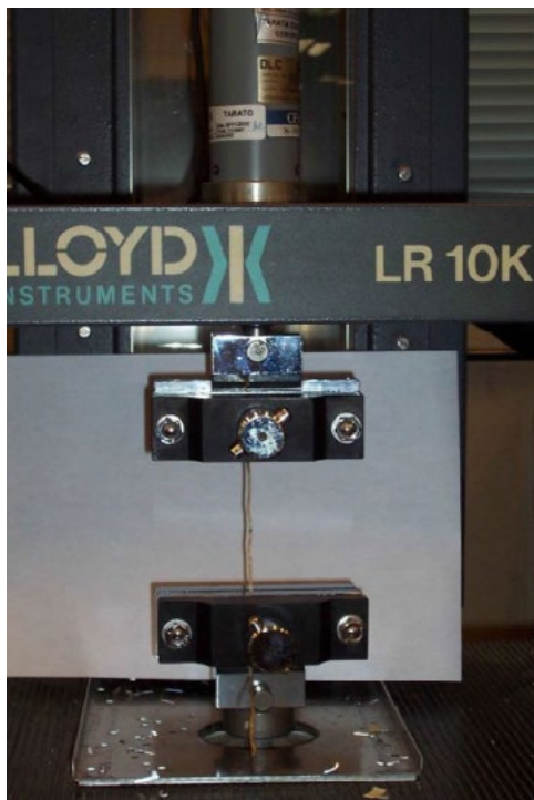
A sinistra, figura 2. Apparecchiatura per le prove di trazione su radici (da CAZZUFFI, CARDILE, GIOFFRÈ 2014, p. 9); in alto, figura 3. Campionamento mediante procedura di rimozione del terreno con acqua pressurizzata (da CAZZUFFI, CARDILE, GIOFFRÈ 2014, p. 8).
